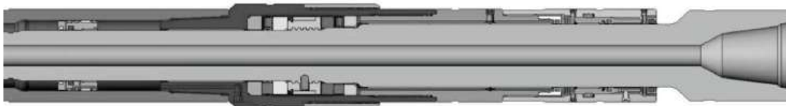
Figura 1 - Motor de Fundo em Corte
